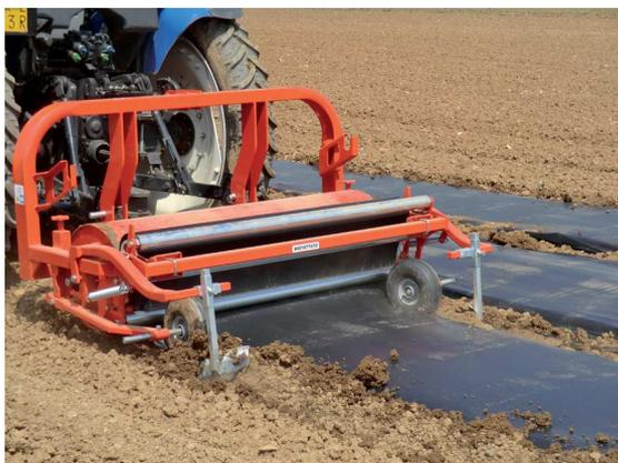
i bordi con del terreno per evitare che colpi di vento possano creare danni. L’attrezzatura può essere dotata di vari accessori come ad esempio lo stendi manichetta. È possibile notare dalla seconda foto come il terreno subito sotto la superficie fosse ancora umido (lo si nota dalle zolle che sono sulla superficie del telo)
