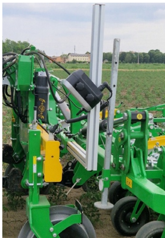
Figura 31 Immagine raffigurante la struttura della sarchiatrice ottica. Si vuole evidenziare il sistema di visione artificiale per il riconoscimento delle infestanti e della pianta di pomodoro.
