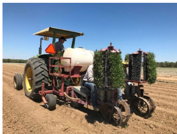
Figura 12 Trapianto meccanizzato del pomodoro da industria con distribuzione simultanea di biostimolante liquido
